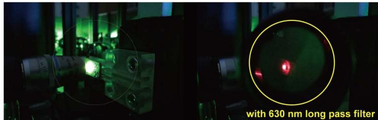
図1: 波長  $532\text{ nm}$  の緑色レーザー入射時のダイヤモンド試料の写真。緑色カットフィルタなし(左)とあり(右)。入射した 緑色光の一部が赤色光になって返って来ることが分かる。
