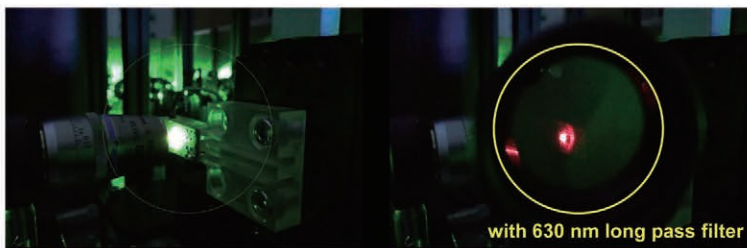
図1: 波長532 nmの緑色レーザ入射時のダイヤモンド試料の写真。緑色カットフィルタなし(左)とあり(右)。入射した緑色光の一部が赤色光になって返って来ることが分かる。
