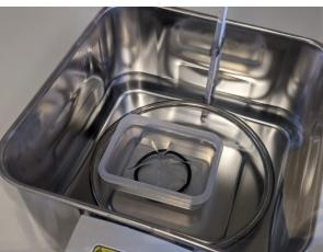
Etching data Etching liquid : HF 46% Tempereture : 25°C
