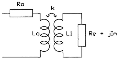
$$Z_C = R_0 + jL_0\omega + \frac{k^2 L_0 L_1 (H_{DC}) \omega^2}{R_e(H_{DC}) + jL_1(H_{DC})\omega + jI_m(H_{DC})}$$
